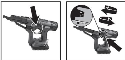
2. Réglez la fraisure en tournant la molette de réglage de la profondeur.
