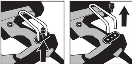
2. Inserte la placa roscada en el lado opuesto de la herramienta y vuelva a instalar el gancho en la posición deseada usando la placa de bloqueo y el tornillo de mariposa.
