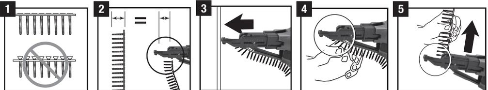
2. Vérifiez que la longueur de la fixation est bien réglée (voir « Réglage en fonction de la longueur de la fixation » ci-dessus).
